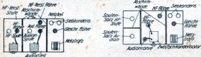
Abb. 7. Bei Einknopf-Abstimmung ist dieser Aufbau empfehlenswert. Die Spulen sind sorgfältig gegeneinander abgestimmt.
